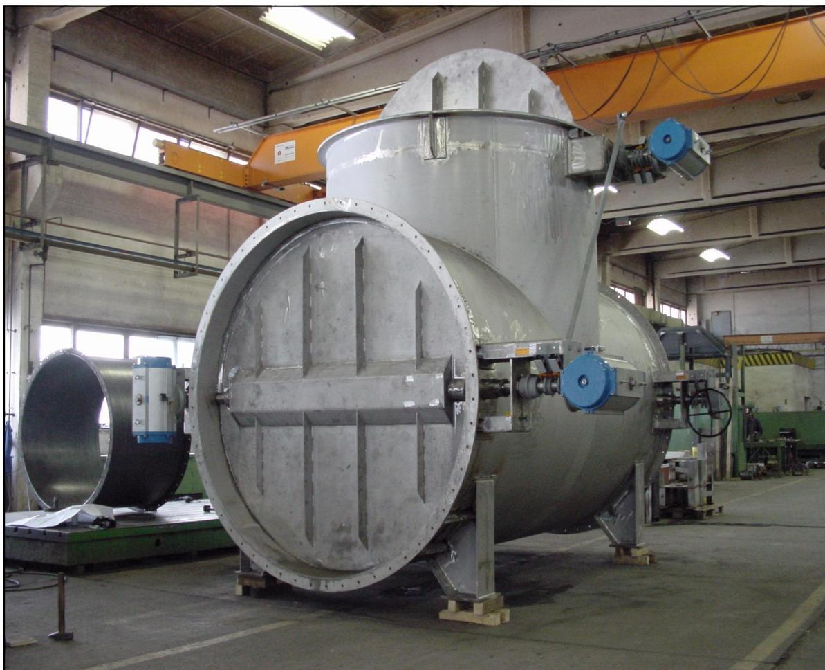
Die untenstehende Abbildung zeigt 6 der insgesamt 13 gelieferten Tandemklappen DN 1300 mm.
