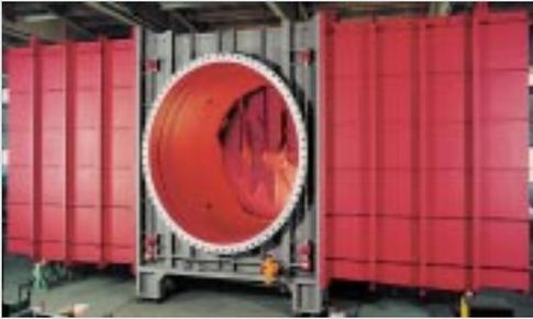
**2001** RAUMAG-JANICH lieferte zum ersten mal die neu entwickelten Brillenschieber und Lenkhebelklappen für das gichtgasgefeuerte Kraftwerk Mittelsbühen. Aufgrund der verbesserten Technologie wurde der Auftrag erteilt.
