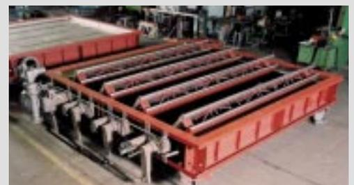
**2002** Lieferung und Montage von zwei Tandemklappen für die REA des Kraftwerkes Buschhaus. Die patentierte Gitterbauweise der Klappenflügel verringert den Querschnittsverlust in Offenstellung von ca. 30% auf 7% (Bild rechts) und hilft somit Energie zu sparen. Diese Lieferung ersetzt im Rahmen einer Neuzustellung Klappen welche von JANICH 15 Jahre zuvor geliefert wurden.
