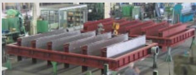
**2007** Für das größte russische GUD-Kraftwerk in Moskau liefert RAUMAG-JANICH über ZURLU Energy, Türkei, 6 DIVERTER NW 3048 x 3048 mm. Die DIVERTER sind innen isoliert. (Bild rechts) Der Kunde entschied sich für die Technology von RAUMAG-JANICH.
