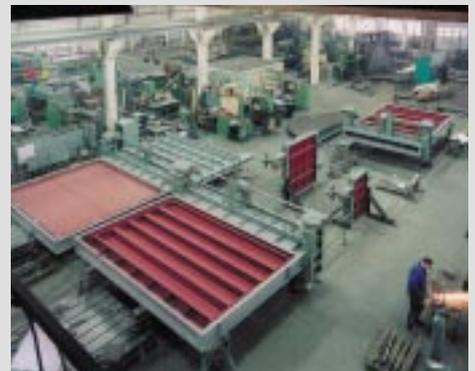
**2001** RAUMAG-JANICH liefert im Auftrag von LOESCHE die Absperrschieber für die größte Kalksteinmahanlage der Welt auf TAIWAN. Das BILD oben zeigt die Schieber bei der Endmontage und den Probeläufen im Werk Rauenstein.
