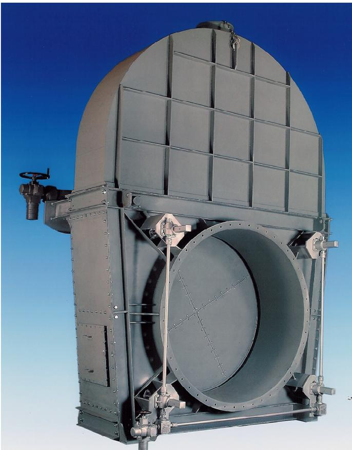
**Sichelschieber DN 2300** mit gasdichtem Gehäuse für die Absperrung einer Rohrmühle in einem Zementwerk. Der Schieber ermöglicht eine Absperrung **nach UVV**. Die Absperrung entspricht einem Blindflansch— Abschluss, so dass das Wartungspersonal bei abgesperrter Mühle hinter dem Schieber durch die heißen Ofenabgase nicht gefährdet ist.
