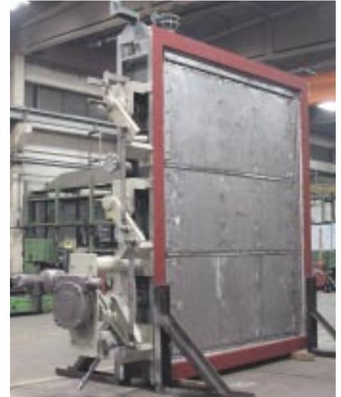
*Oben links:* **Tandem-Absperrklappen** DN 1300 aus Edelstahl. 100% gasdicht mit Sperrluft nach UVV.
