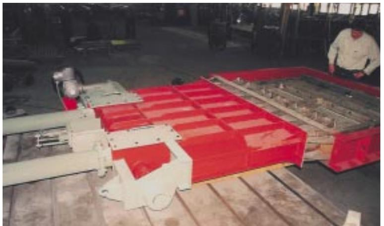
**Jalousieklappen** werden zum Absperren und Regeln von Rauchgasströmen eingesetzt. Entsprechend der Einbausituation werden sie in runder und rechteckiger Form ausgeführt. Mit dem Dichtsystem NICROFLEX wird eine flächenäquivalente Dichtigkeit von mindestens 99,98% erreicht. Mit Doppelabsperrrklappen und Sperrluft wird eine 100% dichte Abspernung nach UVV erreicht.
