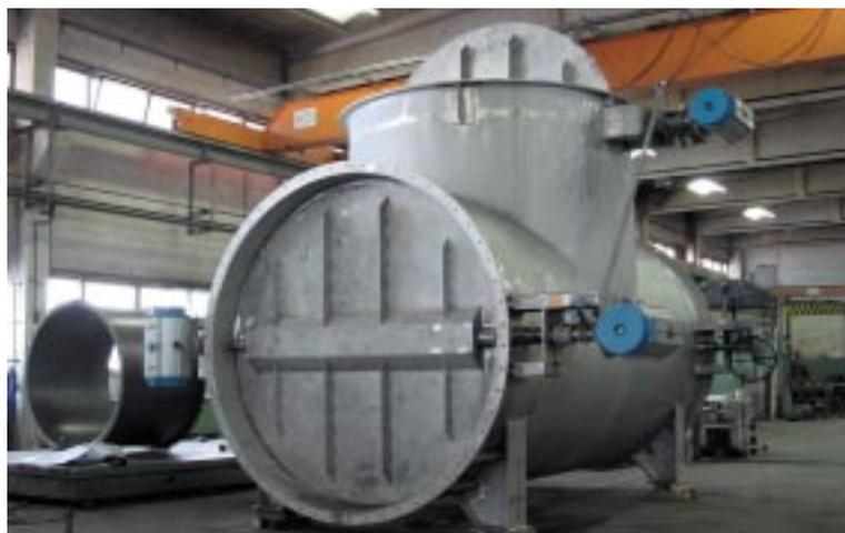
*Unten links:* **Absperrschieber** mit Innenisolierung für eine GT-Anlage. Die Schieberplatte befindet sich im Normalbetrieb außerhalb des Kanals, so dass die Dichtelemente geprüft werden können. Mit Doppeldichtung und Sperrluft 100% gasdicht nach UVV.
