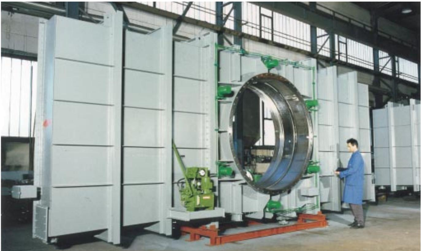
**Lenkhebelklappen** dienen zum Absperrn von Gasleitungen. Sie gelten im technischen Sinne als dichtschließend (DIN 3230).
