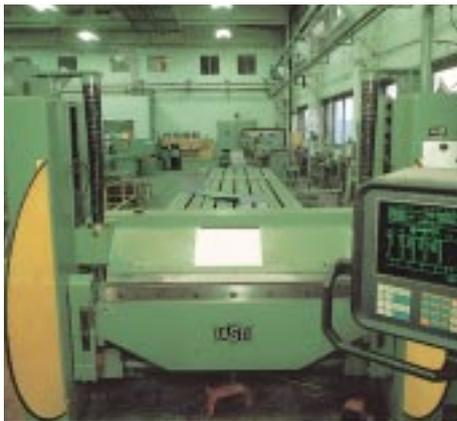
*Oben:* Walzen eines Mantelbleches 3200 mm Durchmesser für einen Zementkühler
