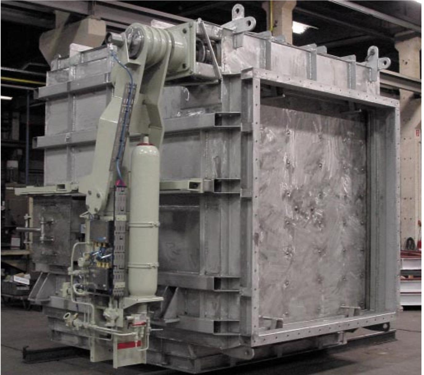
**Diverter NW 2700 x 2700** für eine Off-shore-Gasturbinenanlage in Dänemark. Der Antrieb erfolgt hydraulisch und hat Notlaufeigenschaft.
