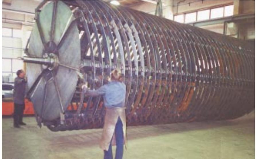
*Oben:* Rotor für einen Zementkühler Durchmesser 3200 mm, Länge 8500 mm
