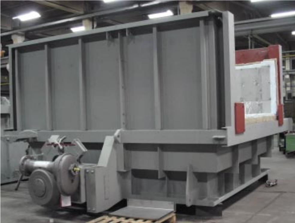
*Links oben:* **Diverter NW 3462 x 3462** in zweiteiliger Ausführung bei der Endmontage im Werk Rauenstein.
