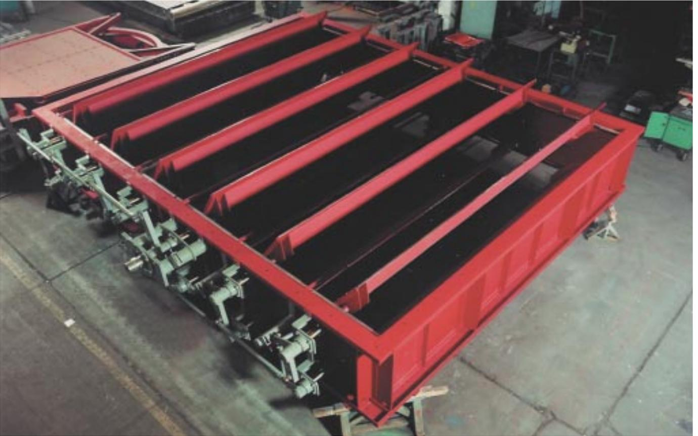
△ **Doppel-Jalousieklappe NW 6780 x 5390** für eine REA. 100% gasdichte Absperrung nach UVV mit Sperrluft. Dichtsystem NICROFLEX-HIPERFORM DBP.
